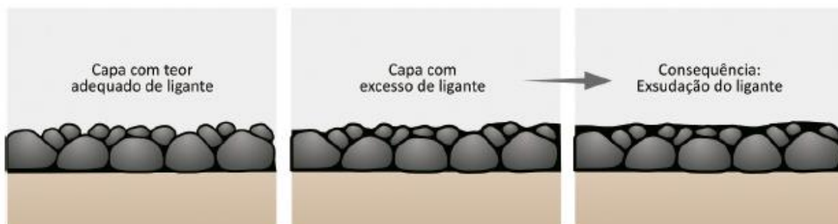
Figura 9: Exsudação do ligante no revestimento
